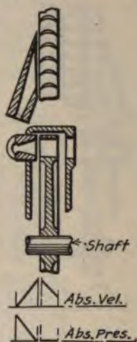
FIG. 24.—Simple impulse turbine.
